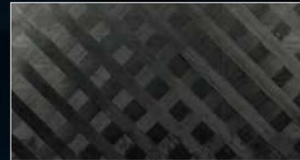
カーボン繊維をX状に織り込むことにより、キャスト時の不要なネジレやタワミを抑え、パワーロスを最小限にとどめることが可能となりました。この素材の採用により、トルク性能と強度が格段に飛躍し、キャスト時の精度や飛距離の向上など、ブランク本来の性能が最大限に発揮できます。
