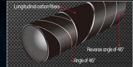
斜め45度にカーボン繊維が通るようにカットされたカーボンプリプレグ。この素材を採用して交互に45度・135度になるように巻きつけたブランクスは、ネジレ剛性を向上させ、細身で高感度・トルクフルなロッドを生み出しました。実釣においては、感度・操作性・キャストビリティー・トルクにおいて揺るぎない真価を発揮します。
